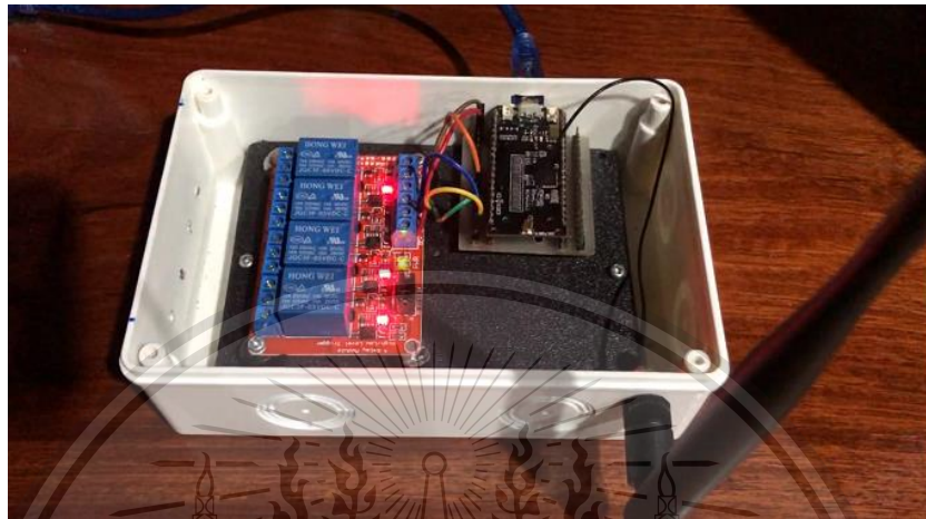
รูปที่ 4.22 รีเลย์ควบคุมแบบ 4 แชนเนล กรณีไก่ที่มีอายุ 35 วันและโรงเรือนอุณหภูมิเฉลี่ยมากกว่า 29 องศาเซลเซียส
