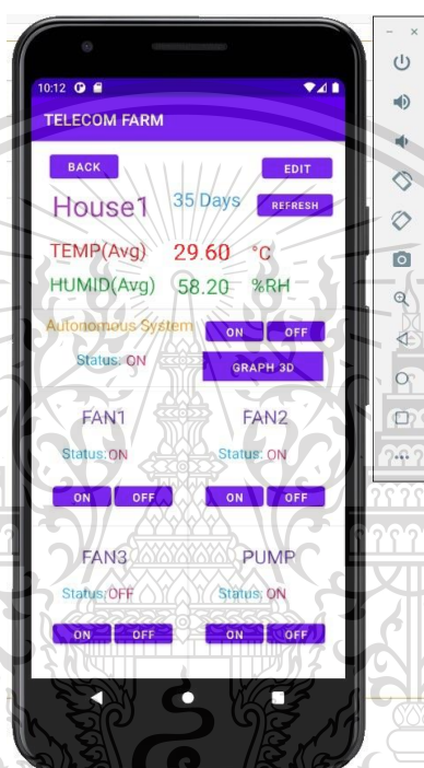
รูปที่ 3.13 สถานะการทำงานรีเลย์แต่ละแขนเนล
