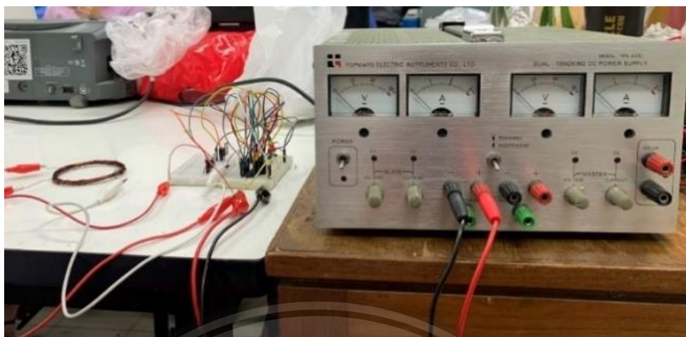
รูปที่ 4.13 วงจรภาคส่งทำการจ่ายแรงดันด้วยเครื่องกำเนิดไฟฟ้ากระแสตรง
