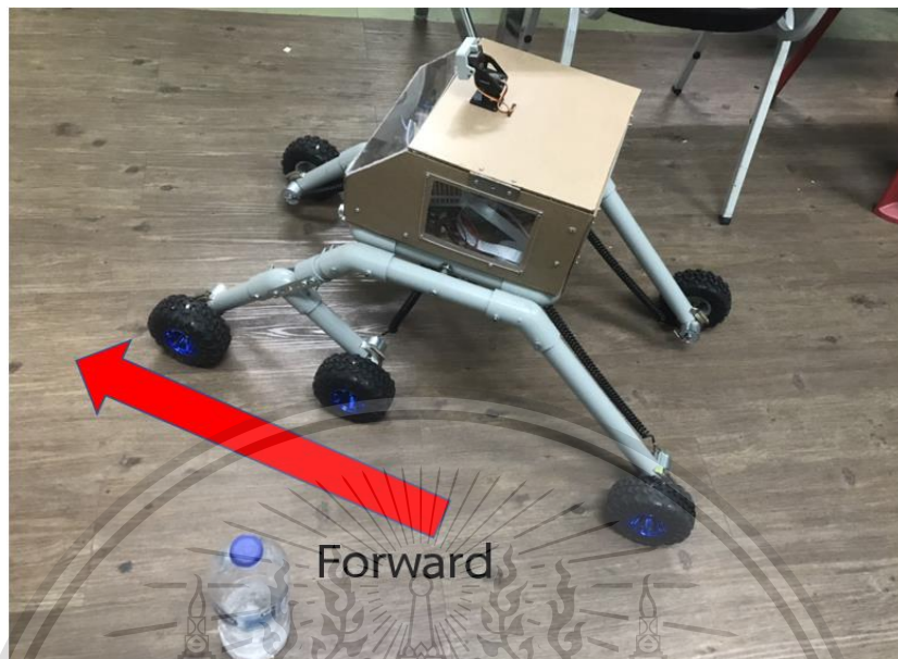
รูปที่ 3.28 เซนเซอร์ตรวจจับไม่พบสิ่งกีดขวางในระยะ 50 cm และสั่งให้โรเวอร์เคลื่อนที่ต่อไป
