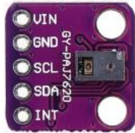
รูปที่ 2.3 เซนเซอร์ตรวจจับท่าทาง
