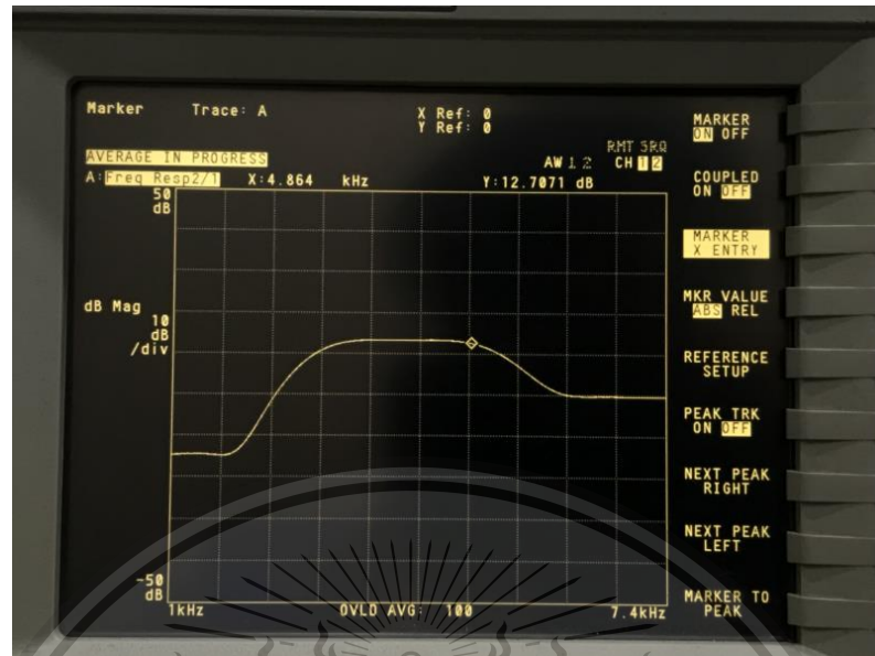
รูปที่ 5.42 ผลการวัด total amplitude response ของ Real Time 3-band Graphic Equalizer โดยให้ค่าเกณฑ์ของ Lowpass filter -15 dB, ค่าเกณฑ์ของ Bandpass filter 12 dB และค่าเกณฑ์ของ Highpass filter 0 dB
