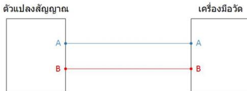
รูปที่ 2.22 การเชื่อมต่อ RS 485 ระหว่างเครื่องมือวัดกับตัวรับสัญญาณ
