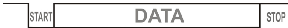
รูปที่ 2.6 การรับส่งข้อมูลแบบ Asynchronous
