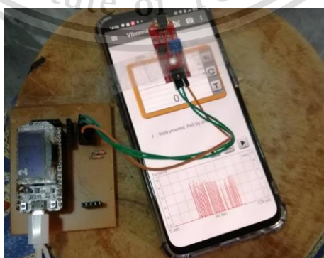
รูปที่ 3.20 รูปแบบการต่อวงจรทดสอบเซนเซอร์ 801S Vibration Module
