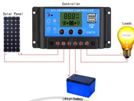
รูปที่ 2.6 การติดตั้งแผงพลังงานแสงอาทิตย์กับแบตเตอรี่ [7]
