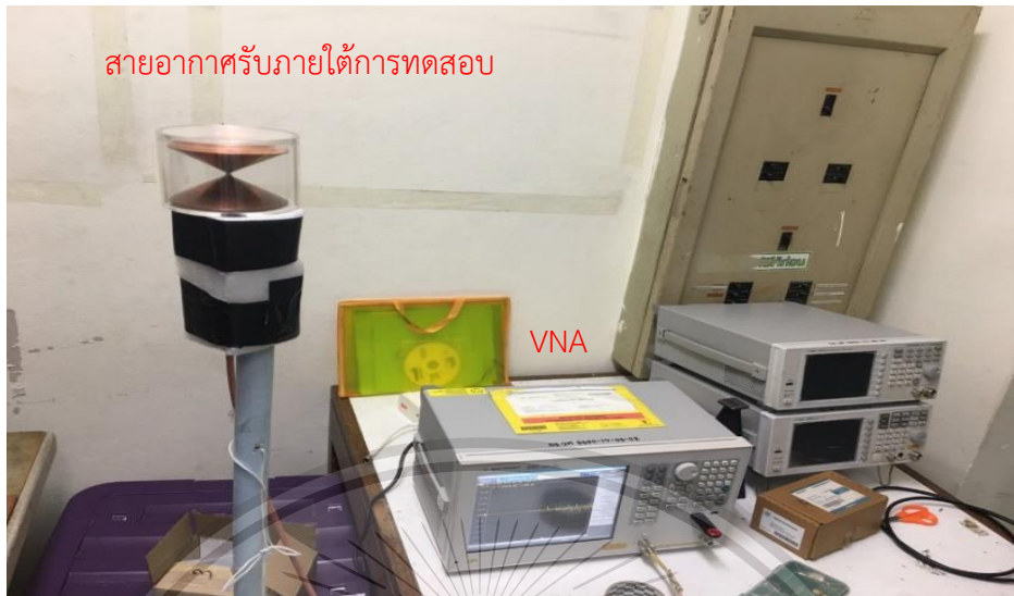
รูปที่ 3.27 การทดสอบสัมประสิทธิ์การสะท้อนและอัตราส่วนคลื่นนิ่งของแรงดัน
