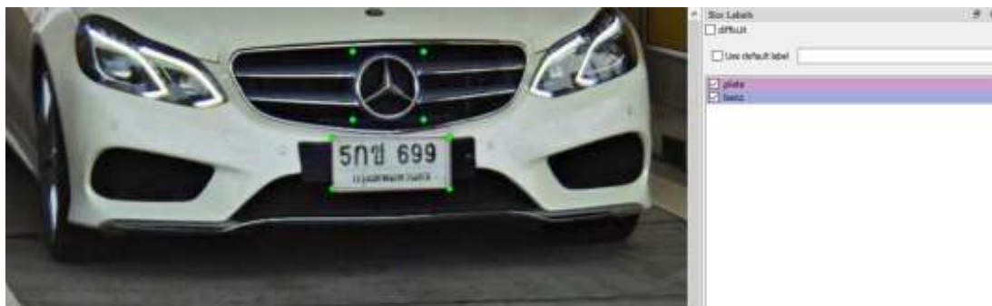
รูปที่ 3.3 การติดป้ายกำกับขอบเขตของวัตถุสำหรับด้านหน้ารถยนต์
