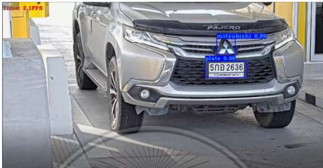
รูปที่ 4.8 ผลการทดสอบกับวิดีโอด้านหน้ารถยนต์ ด้วยอัลกอริทึม YOLOv3
