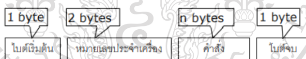
รูปที่ 3.6 แสดงไดอะแกรมส่วนประกอบของคำสั่งชุดหนึ่งชุด
