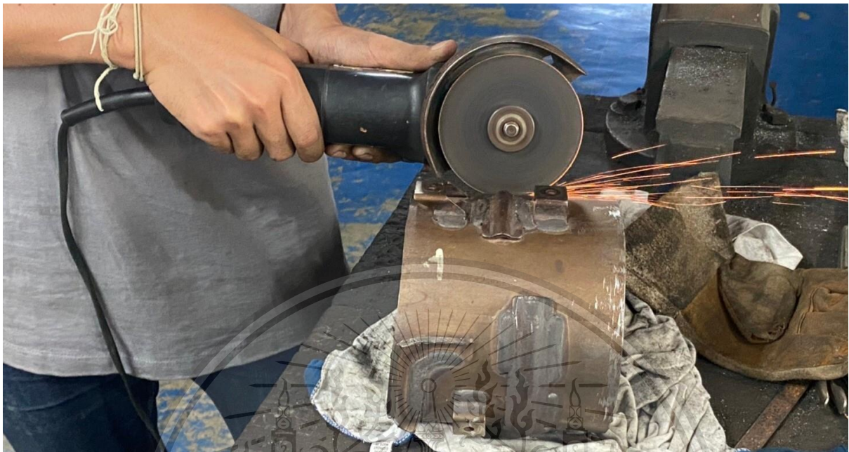
รูปที่ 3.9 ผ่าด้านข้างของตัวเคส
