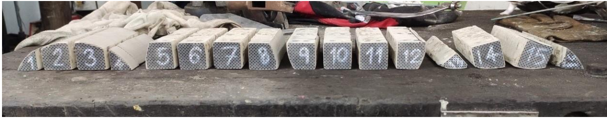
รูปที่ 3.19 DPF ทั้งหมด 16 ชั้นที่แยกส่วนออก
