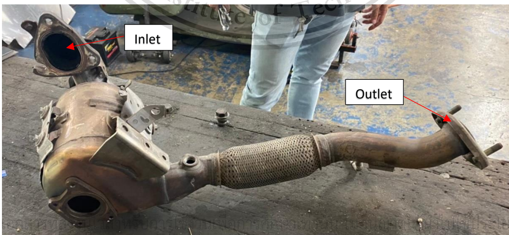
รูปที่ 3.2 ชุดอุปกรณ์กรองมลพิษอนุภาคเขม่าดีเซลของรถยนต์ Mazda2
