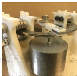
รูปที่ 3.11 แสดงการออกแบบการถ่วงมวลและการควบคุมตำแหน่งของคานโค้ง
