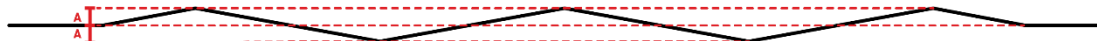
รูปที่ 3.12 มุมข้างของครีบเอียงที่มีอัตราส่วนการขวางการไหลร้อยละ 40 ของระยะห่างระหว่างครีบ
