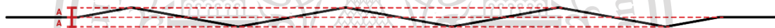
รูปที่ 3.10 มุมข้างของครีบเอียงที่มีอัตราส่วนการขวางการไหลร้อยละ 30 ของระยะห่างระหว่างครีบ
