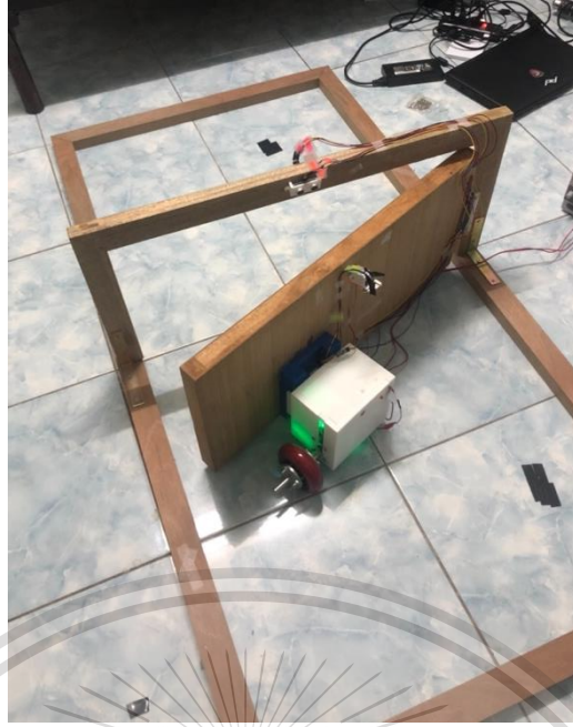
รูปที่ 4.15 แสดงถึงการทำงานของชุดอุปกรณ์เมื่อเซนเซอร์อัลตราโซนิคตัวที่ 2 ตรวจพบวัตถุ
