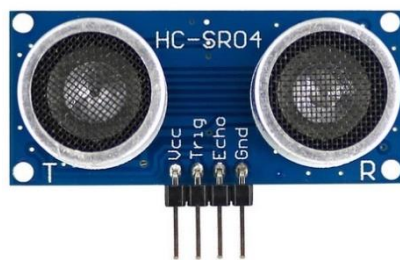
รูปที่ 3.7 แสดงภาพของ Ultrasonic Sensor รุ่น HC-SR04
