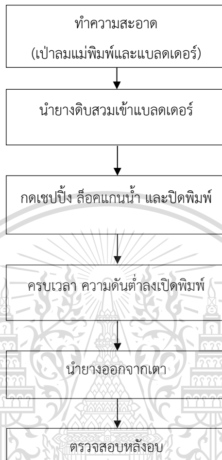
รูปที่ 3.11 การนำยางดิบเข้าอบ
