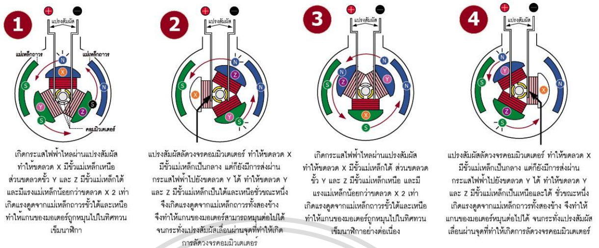
รูปที่ 2.3 แสดงส่วนประกอบและการทำงานของมอเตอร์กระแสตรงแบบขดลวด 3 ขั้ว ซึ่งเป็นแบบที่มีการผลิตใช้งานจริง [5]
