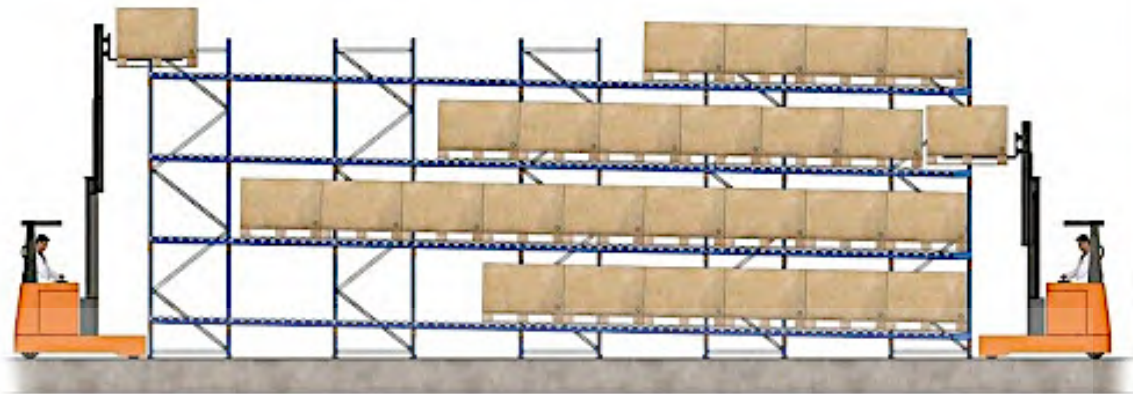
รูปที่ 2.8 ตัวอย่างของชั้นวางแบบ Gravity Flow Rack
