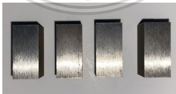
รูปที่ 3.2 โลหะ Bohler k110 ขนาด 20 x 20 x 13 มม.
