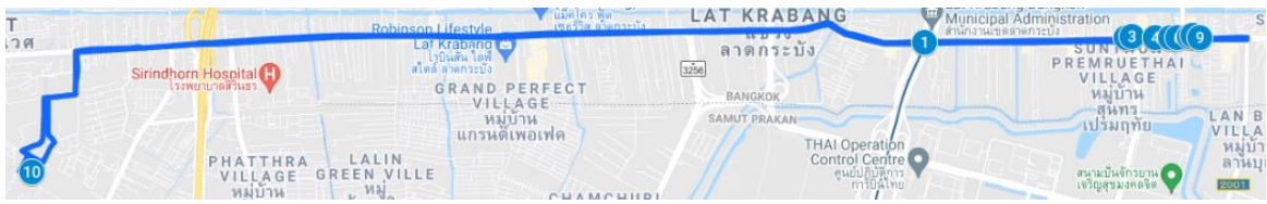
รูปที่ ๗๗๗ ผลลัพธ์ของเส้นทางรถเก็บขยะแบบเก็บ 3 วัน 1 ครั้งของรถคันที่ 2 ของการเก็บขยะวันที่ 1 ด้วยวิธีอิวิริสติก
