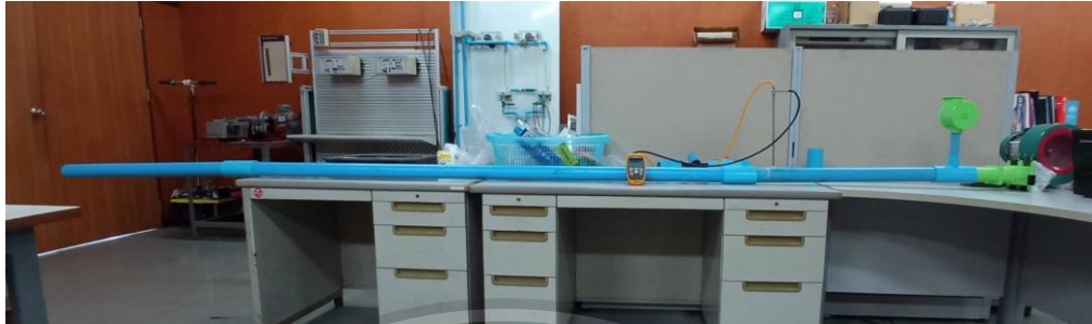
รูปที่ 5.8 ภาพชุดทดลองการหาสัมประสิทธิ์แรงเสียดทานของวัสดุ ( \lambda_s )
