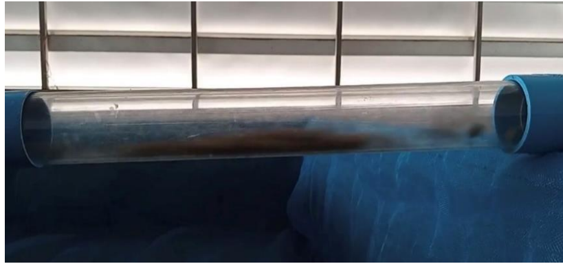
รูปที่ 5.11 การไหลแบบหนาแน่นที่อัตราไหล 0.016 \text{ m}^3/\text{s}
