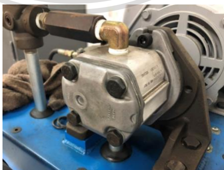
รูปที่ 3.2 ปั๊มประเภท external gear pump
