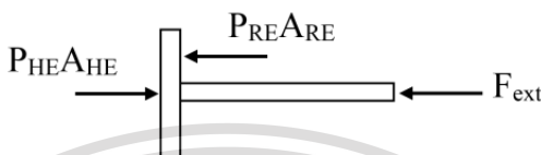
รูปที่ 2.19 แผนผังร่างกายอิสระของลูกสูบกระบอกสูบภายใต้แรงกระทำ
