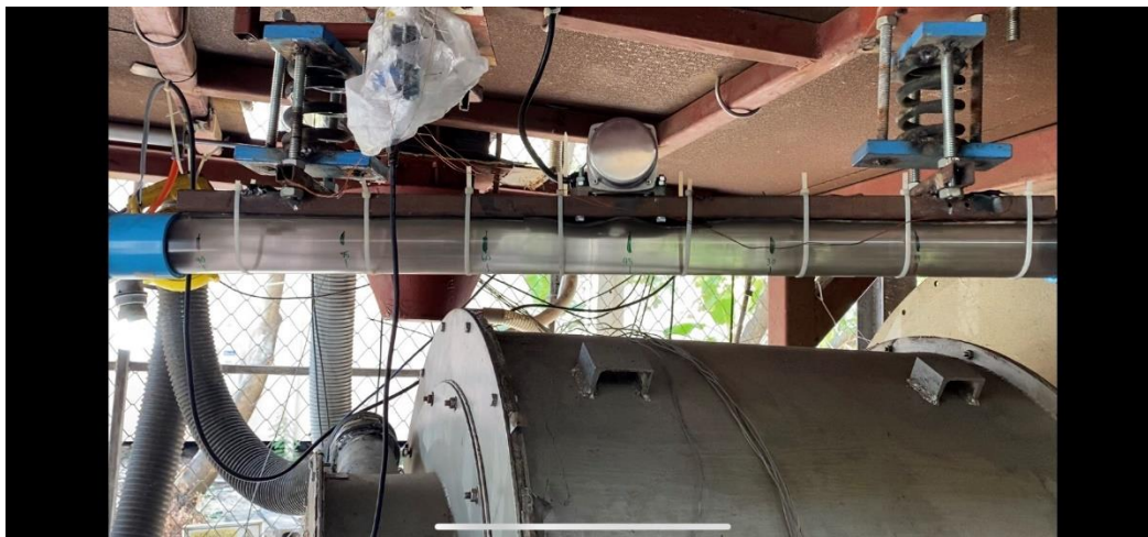
รูปที่ 5. 1 การทดลองการหาประสิทธิภาพของถาดสันสะท้อน
