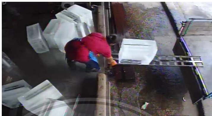
รูปที่ 1.1 การลำเลียงก้อนน้ำแข็งผ่านรางลำเลียงลงสู่กระบะท้ายรถบรรทุก
