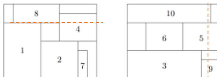
รูปที่ 3.5 แบบการตัดที่ไม่สามารถตัดแนวยาวได้
