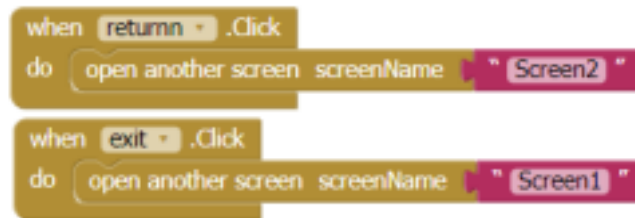
รูปที่ 3.19 การทำงานของ MIT App Inventor ในส่วนการจบการทำงาน
