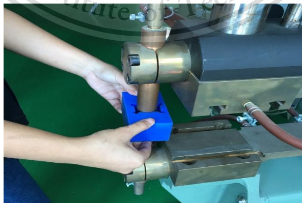
รูปที่ 3.10 การนำชุดแผ่นเหล็ก 2 ชั้นใส่ในอุปกรณ์ยึดจับชิ้นงาน
