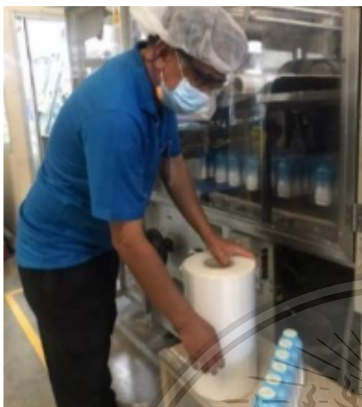
รูปที่ 3.5 การเปลี่ยนพลาสติกหุ้มแพ็คผลิตภัณฑ์
