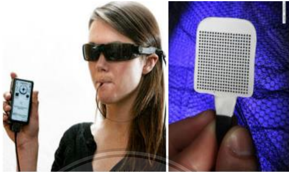
รูปที่ 1.2 อุปกรณ์ Brainport V100 อุปกรณ์ช่วยเหลือการมองเห็นของผู้พิการทางสายตา (ที่มา: https://board.postjung.com/657059 )
