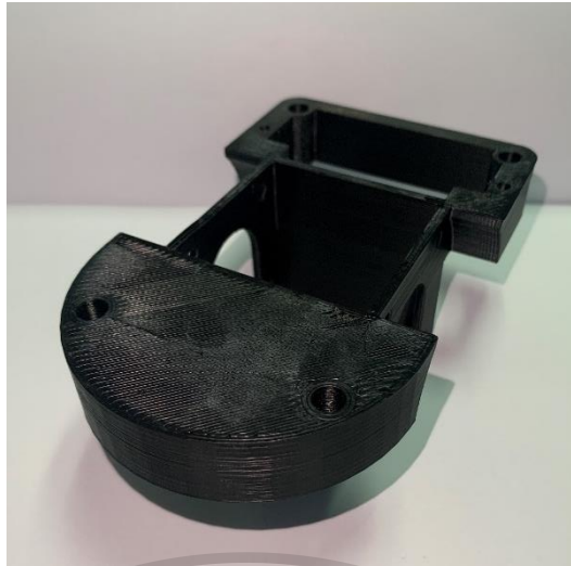
รูปที่ 4.2 โครงหลักของหุ่นยนต์ Micromouse ที่ถูกพิมพ์โดยเครื่องพิมพ์สามมิติ
