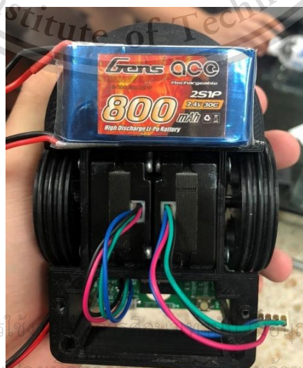
รูปที่ 4.10 หุ่นยนต์ Micromouse ที่ทำการประกอบเข้ากับแบตเตอรี่
