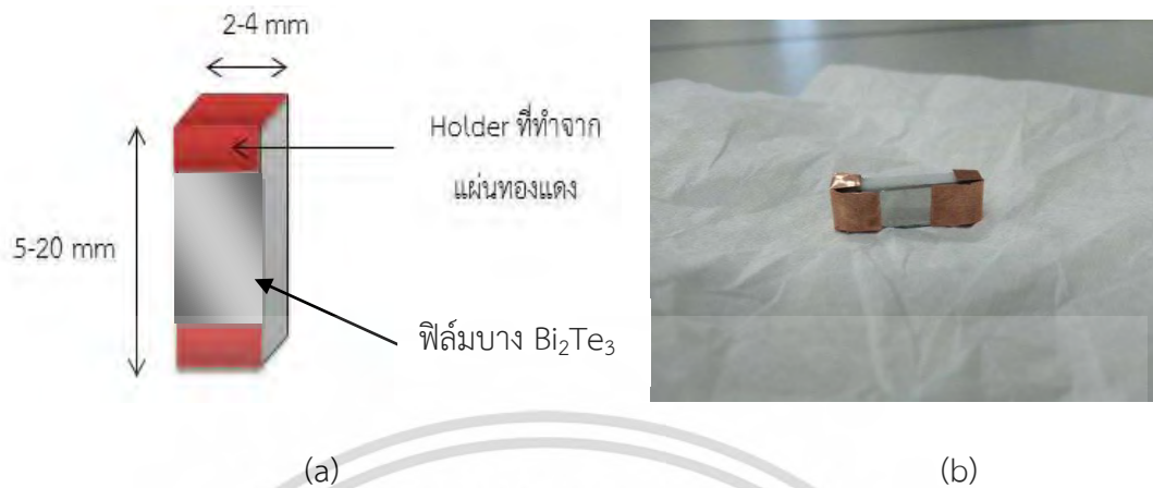
รูปที่ 3.6 (a) แสดงแบบจำลองชิ้นงานที่ติด holder (b) ลักษณะชิ้นงานจริงที่ติด holder แล้ว
