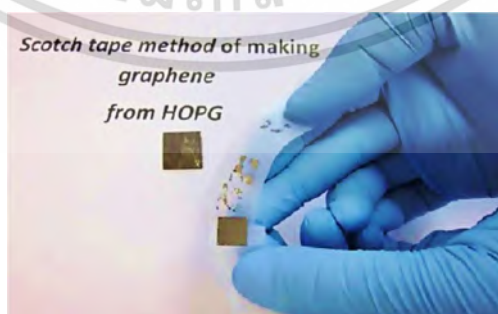
รูปที่ 2.9 การสังเคราะห์กราฟีนด้วยวิธี Mechanical exfoliation [23]
