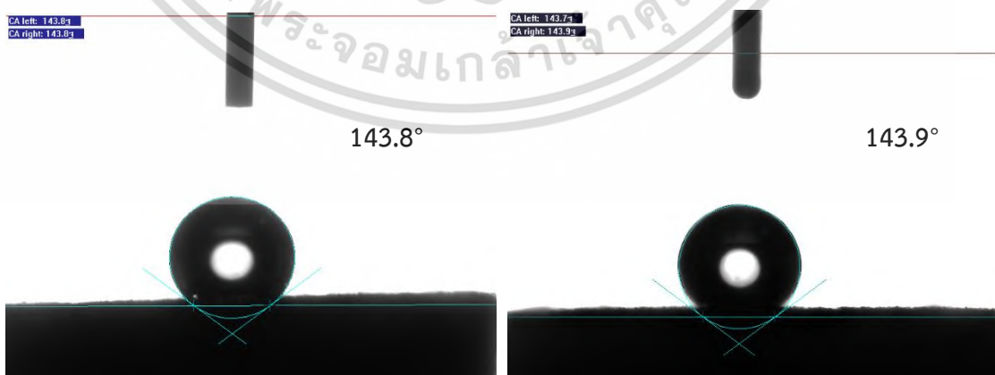
รูปที่ ๓-5 แสดงค่ามุมสัมผัสของหยดน้ำบนเมลามินพอร์มัลดีไฮด์โพลิเอทิลีนไกลคอลเคลือบด้วยรีติวซ์กราฟีนออกไซด์ ที่ใช้เวลาในการให้ความร้อน 30 นาที
