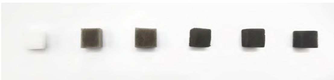
รูปที่ จ-3 แสดงภาพถ่ายของเมลามีนฟอร์มัลดีไฮด์โฟมก่อนและหลังเคลือบด้วยรีติวซ์กราฟีนออกไซด์ เอกสารนี้เป็นเอกสารที่ใช้ปริมาณกราฟีนออกไซด์ตั้งแต่ 1 3 5 10 และ 15 มิลลิกรัม (จากซ้ายไปขวาตามลำดับ) การค้าไม่ว่ากรณีใดๆ ทั้งสิ้น อีกทั้งห้ามมิให้ตัดแปลงเนื้อหา และต้องอ้างอิงถึงเจ้าของเอกสารทุกครั้งที่มีการนำไปใช้
