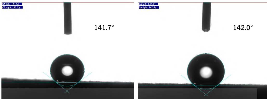
รูปที่ ฉ-12 แสดงค่ามุมสัมผัสของหยดน้ำบนเมลามีนพอร์มัลดีไฮด์โพลีเอไมด์เคลือบด้วยรีดิวซ์กราฟีนออกไซด์ที่ใช้ปริมาณกราฟีนออกไซด์ตั้งต้น 15 มิลลิกรัม
