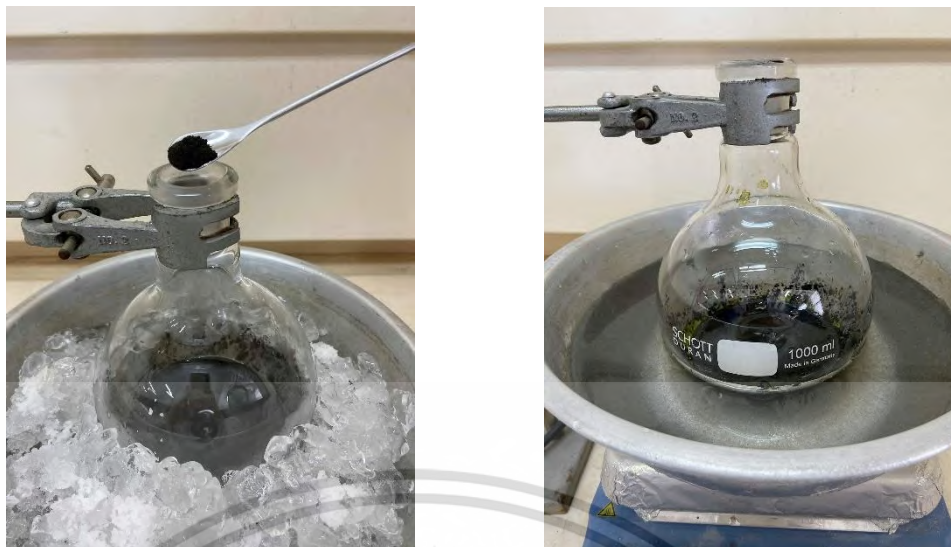
รูปที่ 3.3 แสดงการเติมโพแทสเซียมเปอร์แมงกาเนต และปั่นกวนต่อในอ่างน้ำร้อน
