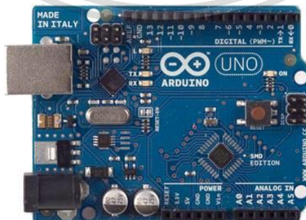
รูปที่ 2.25 Arduino Uno SMD เอกสารนี้เป็นเอกสารที่สงวนไว้สำหรับการใช้งานเพื่อการศึกษเท่านั้น ไม่อนุญาตให้นำไปใช้ประโยชน์ด้านการค้า ไม่ว่ากรณีใดๆทั้งสิ้น อีกทั้งห้ามมีเหตุใดปะปนเนื้อหา และต้องอ้างอิงเจ้าของเอกสารทุกครั้งที่มีการนำไปใช้
