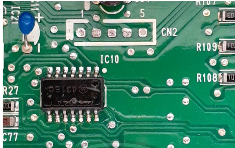
รูปที่ 3.2 วงจรในกล่อง ECU ที่มีการเพิ่ม IC
