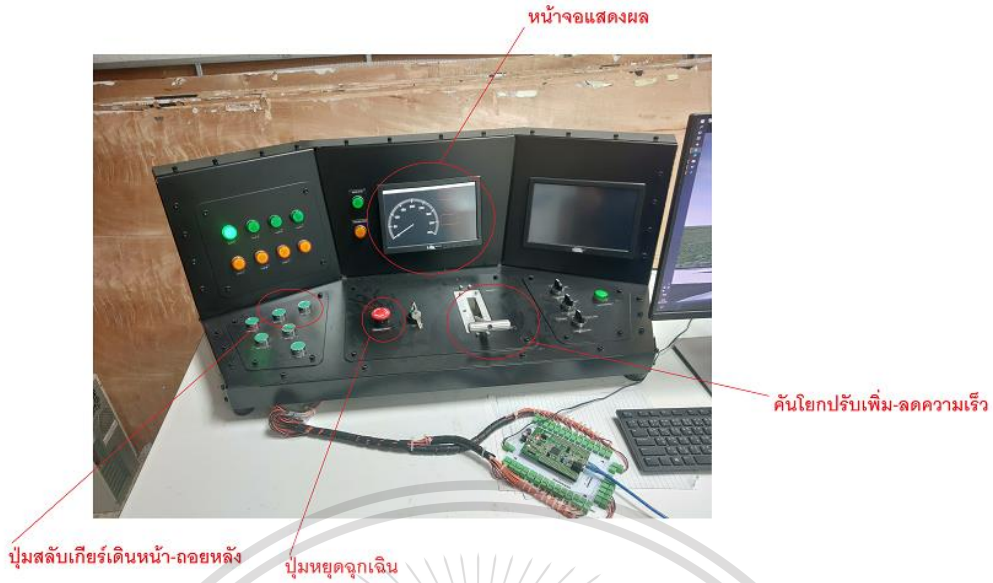
รูปที่ 4.17 องค์ประกอบต่างๆของคอนโซลจำลอง
