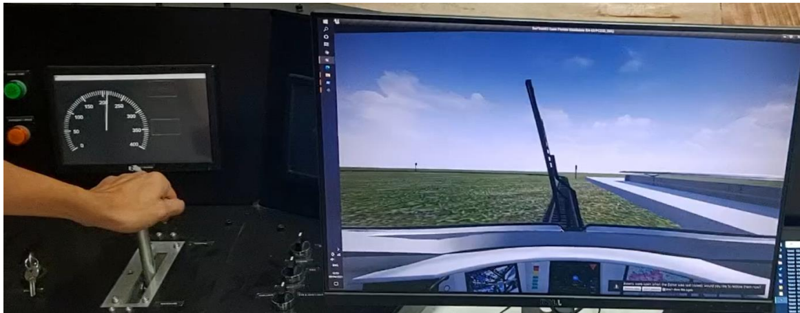
รูปที่ 4.23 การทำงานของหน้าปัด และคันโยกเช่นเดิมในขณะที่รถไฟถอยหลังอยู่
