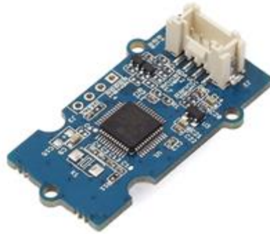
รูปที่ 2.14 บอร์ด Grove - Finger-clip Heart Rate Sensor [15]
