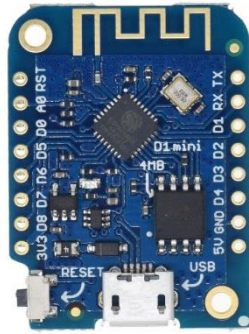
รูปที่ 2.12 บอร์ด WeMos D1 mini ESP8266 [13]
