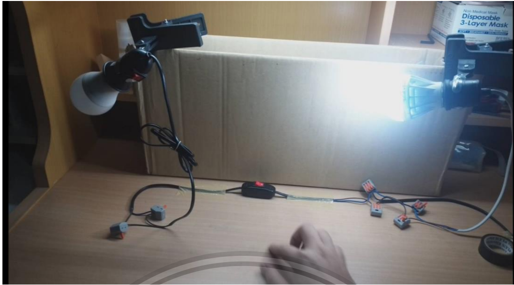
รูปที่ 4.3 จำลองวงจรหลอดไฟบนเส้าไฟฟ้า1 (กรณีมีสายไฟขาด)
