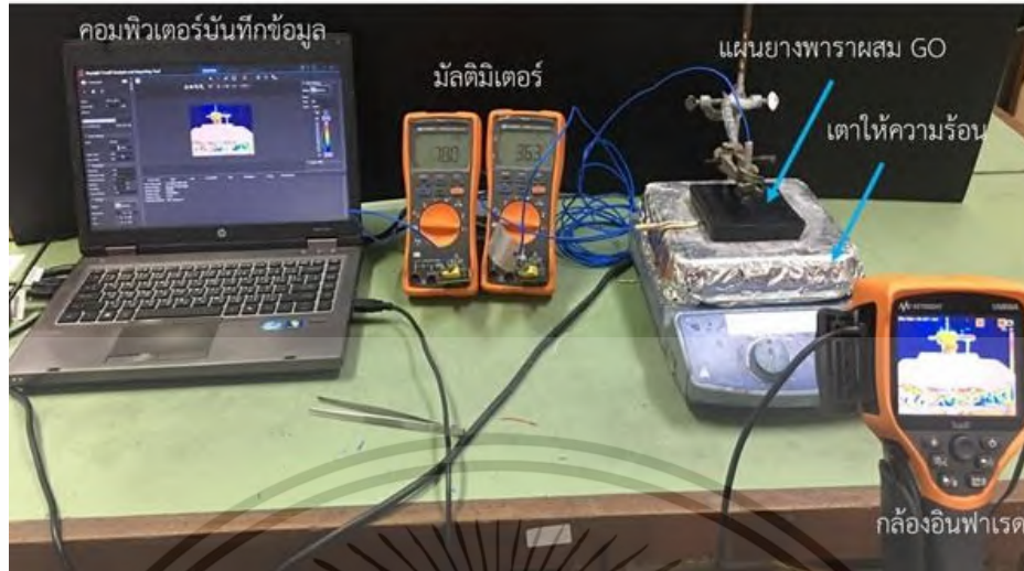
รูปที่ 3.5 อุปกรณ์ทดลองการกระจายความร้อนด้วยกล้องอินฟราเรด
