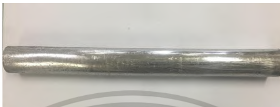
รูปที่ 3.15 แท่งอินก๊อท \text{Bi}_2\text{Te}_3 ชนิดเอ็น
