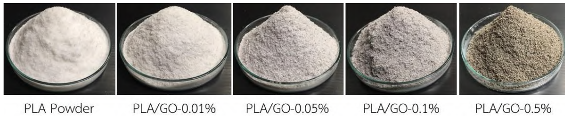
รูปที่ 3.9 ผงพอลิเมอร์ผสมกราฟีนออกไซด์ PLA, PLA/GO-0.01%, PLA/GO-0.05%, PLA/GO-0.1%, และ PLA/GO-0.5%
