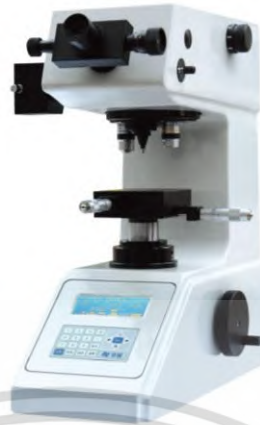
รูปที่ 2.21 เครื่องทดสอบความแข็งแบบวิกเกอร์
