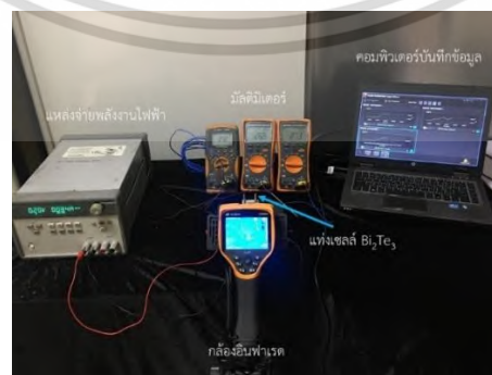
รูปที่ 3.22 ชุดอุปกรณ์ในการทดสอบจ่ายกำลังไฟฟ้าให้กับแท่งเซลล์ \text{Bi}_2\text{Te}_3
