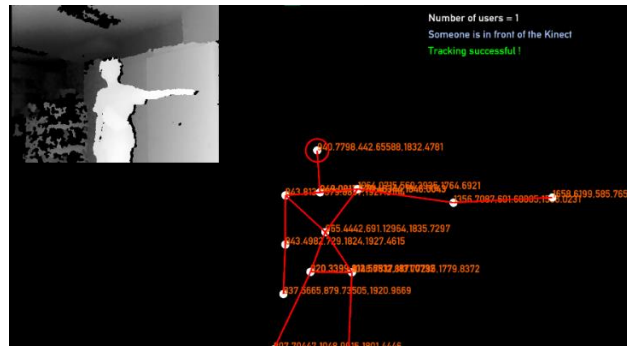
รูปที่ 4.12 การทดลองหาค่าพิกัดบน Skeleton ในมุม 0-45 องศาโดยวางอุปกรณ์ 45 องศา
