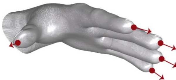
รูปที่ 2.13 เวกเตอร์ตำแหน่งและทิศทางให้ตำแหน่งของปลายนิ้วและทิศทางทั่วไปที่นิ้วชี้
