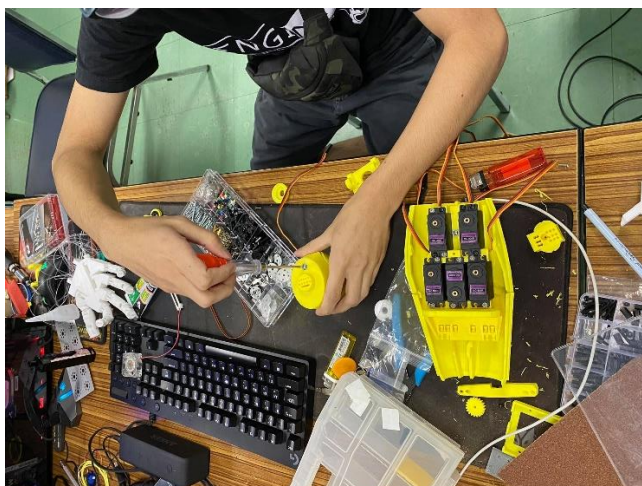
รูปที่ 4.14 การประกอบแขนกลในส่วนข้อมือและติดตั้ง Servo Motor
