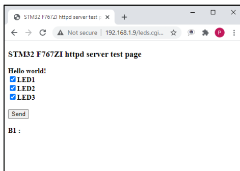
รูปที่ 4.8 การทดลองควบคุม I/O บน STM32 ด้วย Web server และ LwIP
