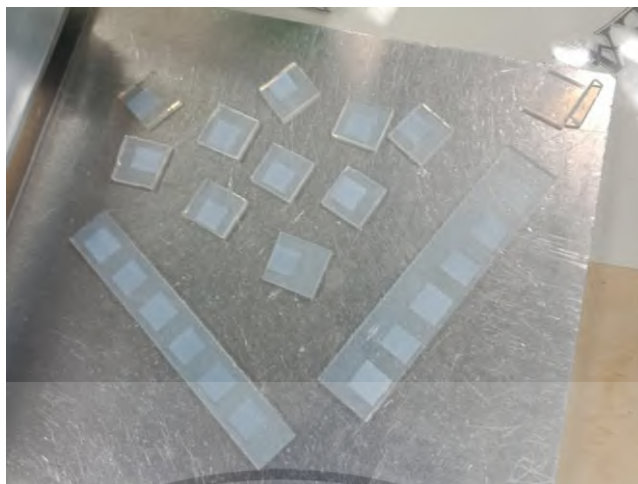
รูปที่ 3.6 ตัวอย่างกระจกนำไฟฟ้าที่มีชั้นฟิล์ม \text{TiO}_2
