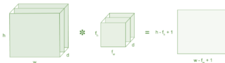
ภาพที่ 2.9 การทำ Convolution Layer
