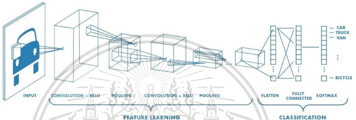
ภาพที่ 2.8 การทำงานของ CNN โดยแบ่งแบบ Layer
