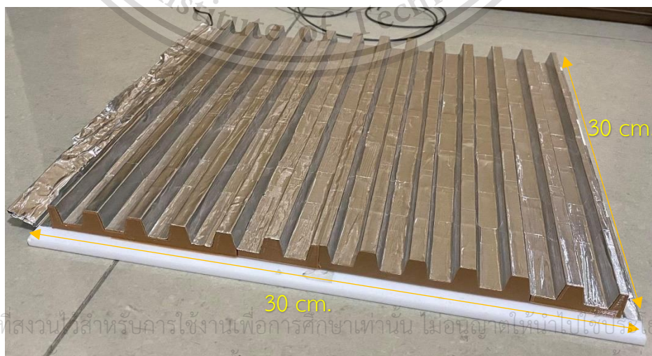
รูปที่ 2 แผ่นอะลูมิเนียมที่ติดกับพื้นเก็บเกี่ยวพลังงานแบบซี่รูปที่ 2
