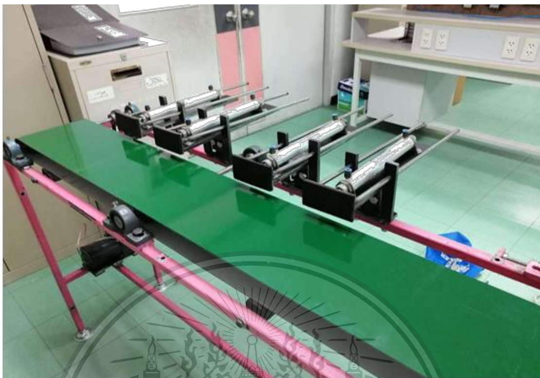
รูปภาพที่ 3-19 ทำการประกอบกระบอบอกสูบเข้ากับสายพานลำเลียง
