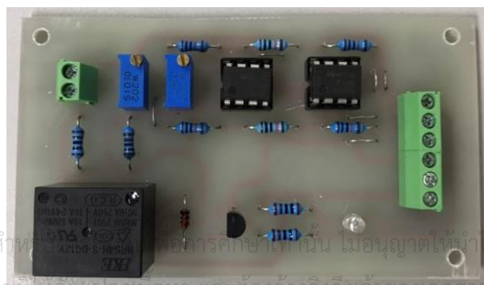
รูปที่ 3.18 แผ่นวงจรที่บัดกรีอุปกรณ์สำเร็จ
