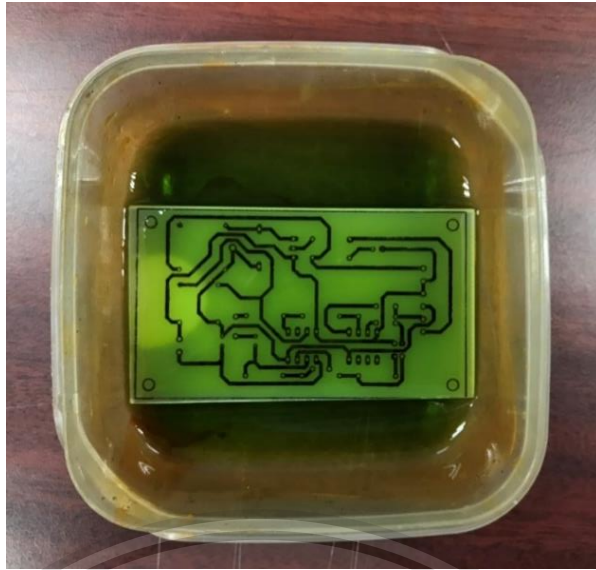
รูปที่ 3.14 แผ่นทองแดงที่กรัดกัดออกจนหมดเรียบร้อยแล้ว
