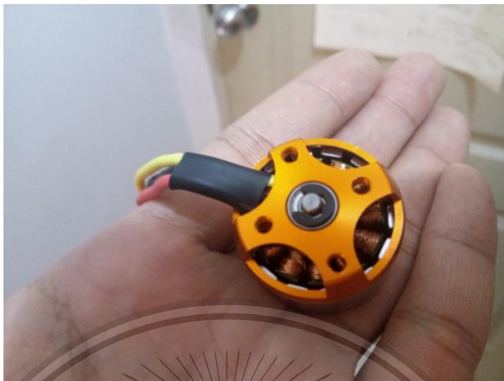
รูปที่ 4.27 โครงสร้างบริเวณตลับลูกปืนที่ทำหน้าที่รับแรงของมอเตอร์ที่คาดว่าจะนำมาใช้งาน
