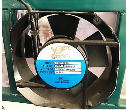
รูปที่ 3.4 ภาพของขนาดพัดลมที่เลือกใช้เพื่อให้สอดคล้องกับการออกแบบ
