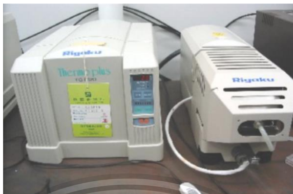
รูปที่ 2.11 แสดงเครื่อง Thermogravimetric analyzer [14]
