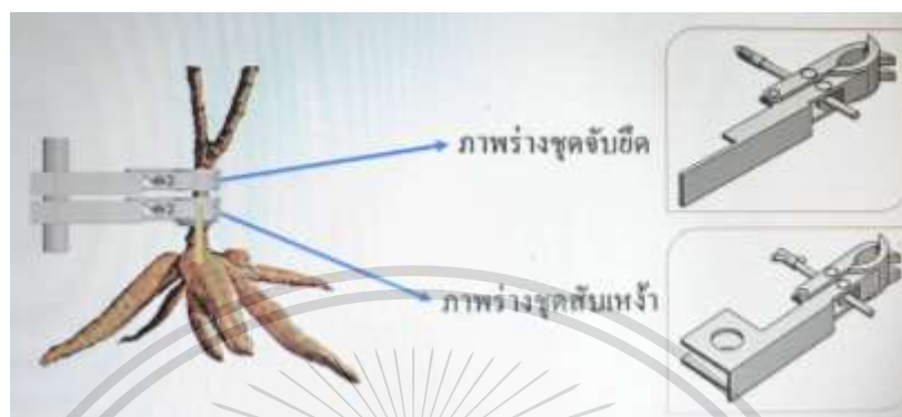
รูปที่ 2.21 ชุดกลไกจับยึดและสับเหง้ามันสำปะหลัง
